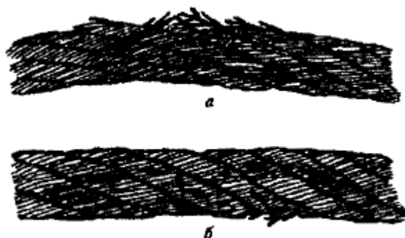
Рисунок 3. Обрывы проволок в зоне уравнильного блока:
