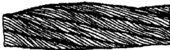
Рисунок 13. Местное увеличение диаметра каната.
